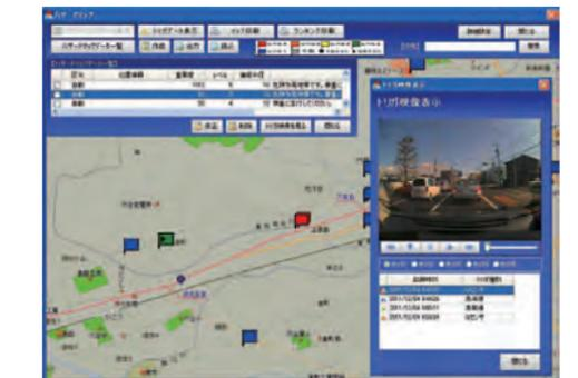
矢崎の解析ソフトは、Gセンサが感知した衝撃・急加速などの位置と回数を分析して、御社専用のハザードMAPを自動作成。運行実態に基づいた危険箇所の把握が可能です。
